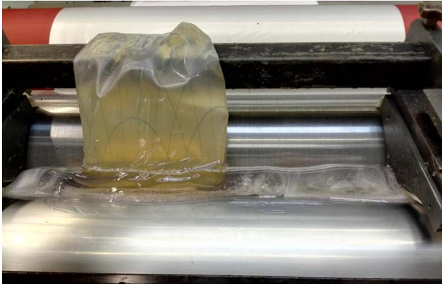
*Abbildung 2: Aufschnelzen des Hotmelts und Übertragung von der Gravurwalze auf die mikroporöse Membran*
